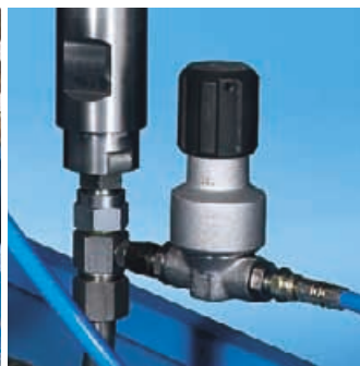
Регулятор служит для поддержания постоянства температуры материала при методе горячего распыления в системе циркуляции.
