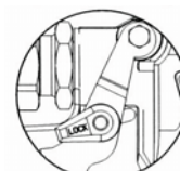
Предохранитель спускового механизма в заблокированном положении
